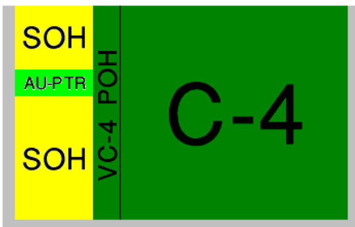
Abbildung 3.12 Administration Unit AU-4
